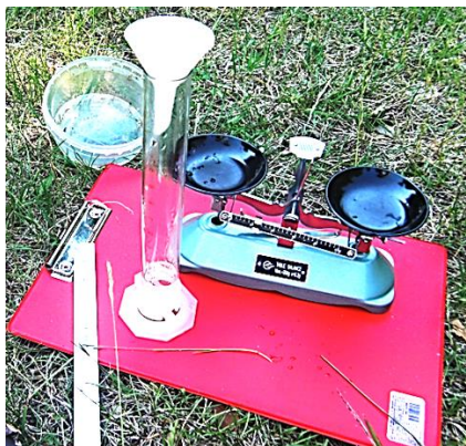
Приложение 2. Подготовка оборудования для определения содержания взвешенных частиц в воде и биомассы зообентоса, 13 июня 2018 года, автор фото: Чальшева Полина.
