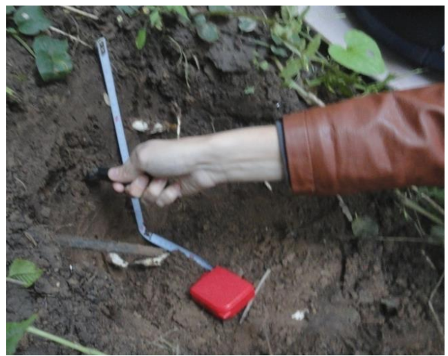
Рис. 11. Определение гранулометрического состава почвы методом жгута (слева) и плотности сложения почвы полевым ножом (справа).
