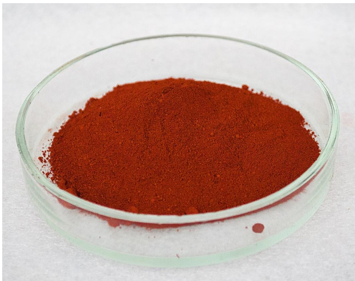
Рис 6. Пигмент готовился путем растирания порошка оксидов, далее охру обжигали при температуре свыше 150°C. Вода из минерала испарялась, и она поменяет свой цвет на красный.
