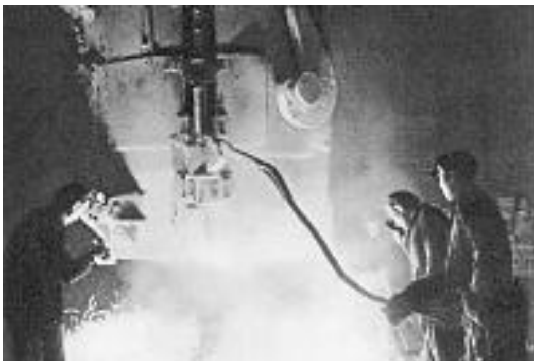
Выплавка стали в мартеновской печи.
